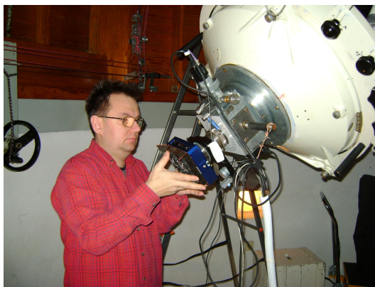
Rysunek 32. Montaż kamery CCD Apogee na teleskopie 60 cm Cassegrain
